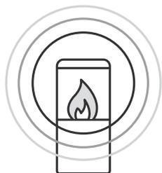
La radiación es el calor que emite directamente el aparato y viaja a través del aire hasta que alcanza un material que puede absorberla. El material expuesto comenzará a calentarse. Este tipo de calefacción se recomienda para habitaciones con techos altos, para casas con exposición al viento o difíciles de calentar y para grandes volúmenes.
